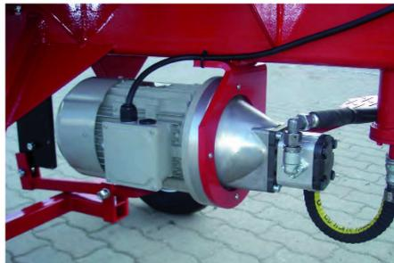
Sehr laufruhige Hydraulikpumpe mit Ölfilter
