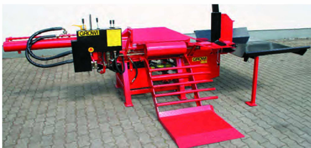
Industrierausführung: GSW 25 Elektro-Turbo mit extremer Spaltgeschwindigkeit
