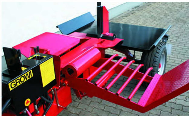
Spalttischhöhe & Stammheber sind optimal abgestimmt
